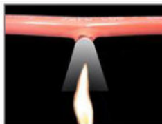
10 Sekunden Der Schlauch platzt, Gas tritt aus und löscht das Feuer
